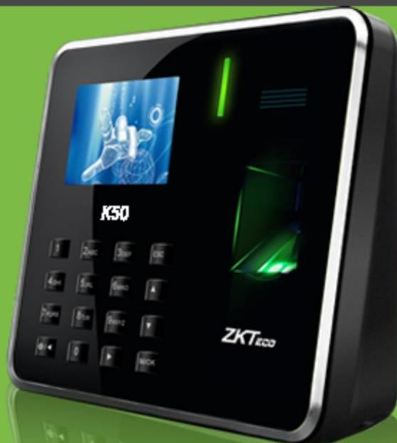
K50 es una elegante e innovadora terminal biométrica IP diseñada para gestionar la asistencia de empleados y controlar el acceso de una puerta.
